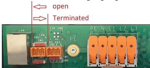
Für die Master- / Slave- Konfiguration der Ladestation ist der Schalter SW4 wie folgt dargestellt zu betätigen:
